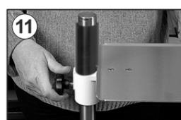
Stecken Sie den Ablagetisch und die schwarze Distanzhülse (mit der Aussparung nach unten) über die Stativsäule und fixieren Sie diesen vorerst weit unten an der Säule.
