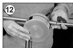
Stecken Sie einen der Ausleger über die Stativsäule und fixieren Sie diesen vorerst etwa in der Mitte der Säule.
