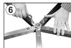
Ziehen Sie mit einem 6 mm Inbusschlüssel alle Schrauben fest an.
